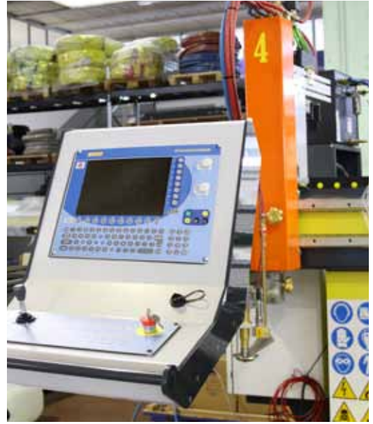
Tastatori capacitivi ed accenditori | Capacitive height control, electric ignition Parcheggio laterale dei carrelli | Side parking of the carriage
