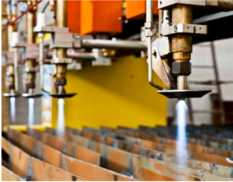
Tastatori capacitivi ed accenditori | Capacitive height control, electric ignition Parcheggio laterale dei carrelli | Side parking of the carriage
