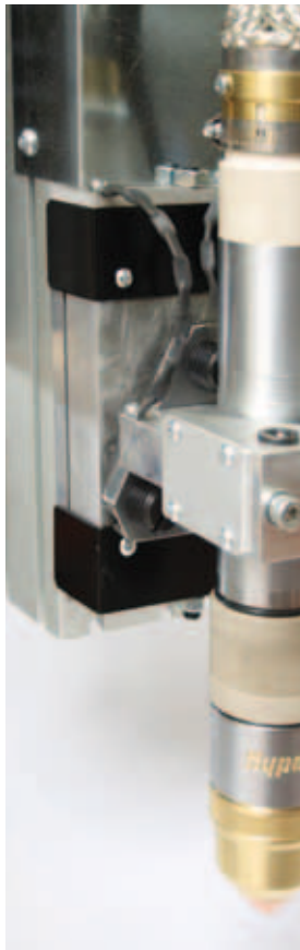
Anticollisione magnetico | Magnetic anticollision device
